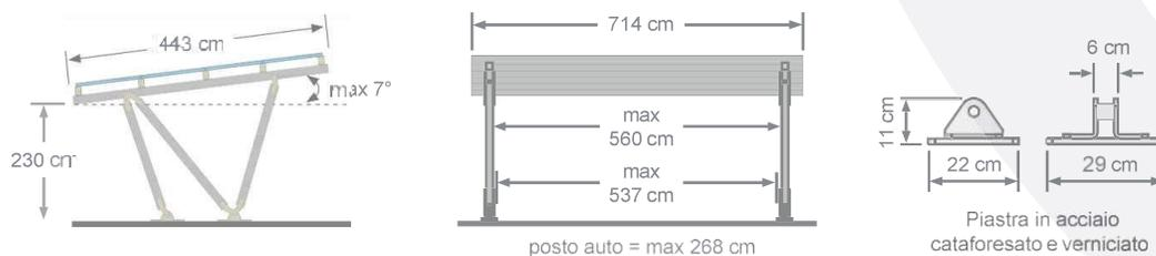
NOTE: La struttura necessita di un sistema di fondazioni per l'ancoraggio al suolo.
